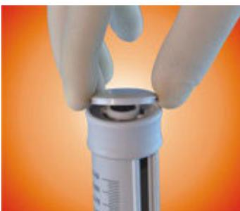
**Calibrazione** - Strumento di calibrazione in dotazione al dosatore; permette una conveniente e rapida calibrazione dello strumento a cura dell'utente in conformità delle norme GLO/ISO. Istruzioni fornite nel manuale d'uso.
